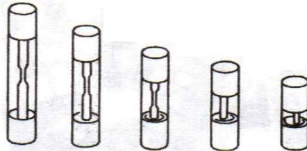
**Fusible de tapón enroscable:** Pieza cilíndrica de porcelana o similar, sobre la cual se pone una camisa roscada que sirve para que sea introducido en el circuito. El alambre (fusible) se coloca internamente, se fija con tornillos y se protege con una tapa roscada.
